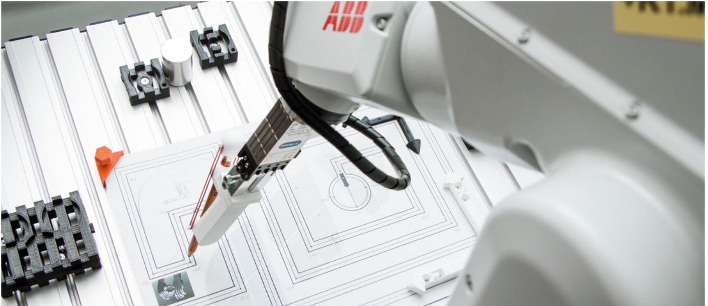
Aktuelle Entwicklungen in der Industrierobotik eröffnen neue Möglichkeiten zum Einsatz von Robotern: Kraftregelung, Bildverarbeitung, intuitive Bedienkonzepte mit der Möglichkeit zur Handführung, sichere Sensorik in Verbindung mit sicherer Steuerungstechnik sind nur einige Beispiele. Im Industrierobotik-Labor üben und testen Studierende das Programmieren eines Industrieroboters mit sogenannten „pick and place“ Aufgaben.
