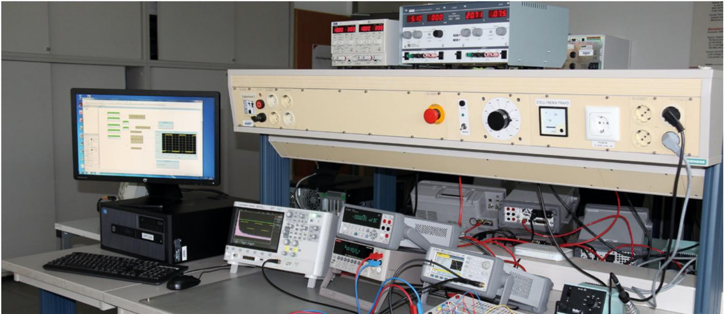
Alle Arbeitsplatzmessgeräte besitzen eine LAN-/LXI-Schnittstelle, sind über einen Ethernet-Switch an den Desktop-Rechner angebunden und somit fernsteuerbar. Mit Programmpaketen wie MATLAB, Keysight-VEE Pro, LabView, C++ etc. ist somit an jedem Arbeitsplatz die Möglichkeit einer automatisierten Messdatenerfassung gegeben.
